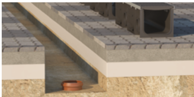
1. Подготовка основания и подключение трубы
